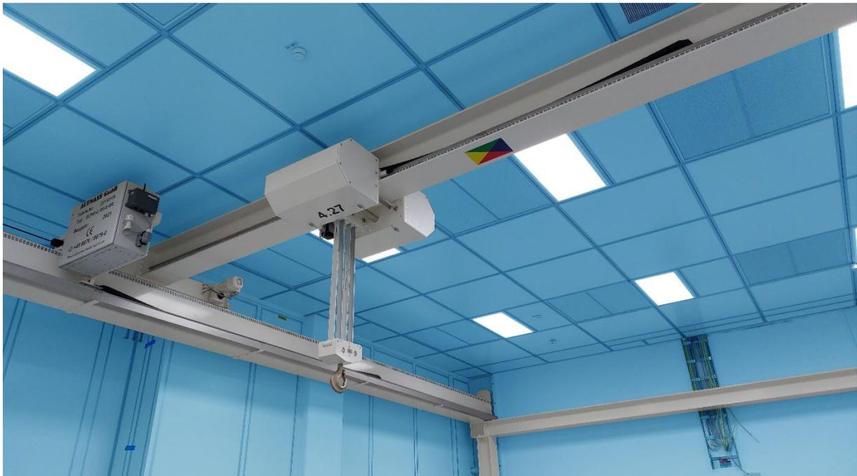
Reinraumkran mit Halbautomatik und Pendeldämpfung - Altmann Fördertechnik
